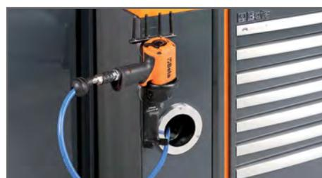
Druckluftzufuhr mit integrierter Ø 8 mm Aufwickelvorrichtung. Länge: 10 m
