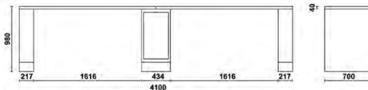
**MIT ARBEITSFLÄCHE 2050X700 MM, VERKLEIDET MIT EINER STOSS- UND KRATZFESTEN PVC-SCHICHT, KOHLENWASSERSTOFFBESTÄNDIG. INTEGRIERTE STECKDOSEN UND AUFWICKLER:**
