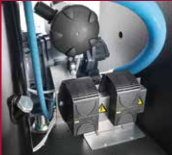
Schalldämmhauben-Heizung: Für Anlagen bei niedriger Umgebungstemperatur
