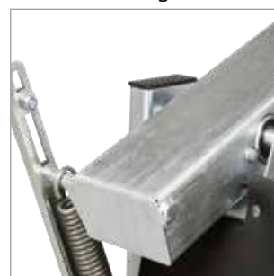
Präziser, justierbarer Rolltischanschlag
