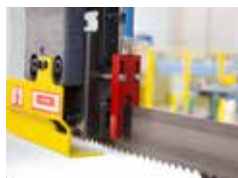
Sägebandführung aus Hartmetall
