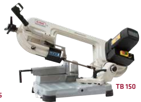
Gut ablesbare Winkelskala - einfache Gehrungseinstellung 0 bis 60°
