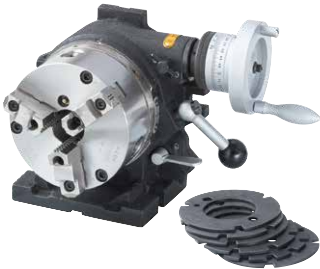
Teilapparat TAHV mit Dreibacken-Drehfutter und sechs präzisen Einrastscheiben für die Teilungen 2 x 180°, 3 x 120°, 4 x 90°, 6 x 60°, 8 x 45°, 12 x 30° und 24 x 15°
