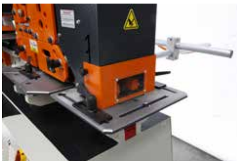
Auslinkstation mit Winkelanschlag
