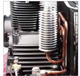
Kühler aus Alu- Druckguss und Kupferkühlleitung
