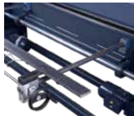
Hinteranschlag mit Handrad & Messeinrichtung
