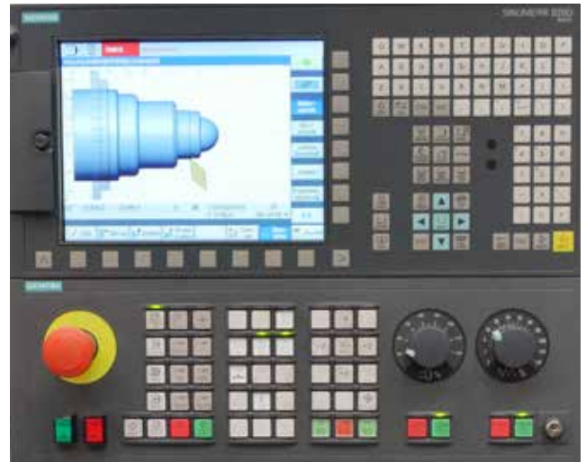
Steuerpanel mit 2 elektronischen Handrädern
