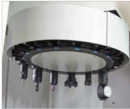
16-fach Werkzeugwechsler S 400
