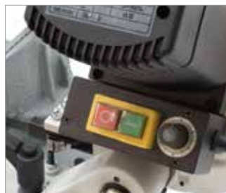
Stufenlos einstellbare Schnittgeschwindigkeit TB 125/150
