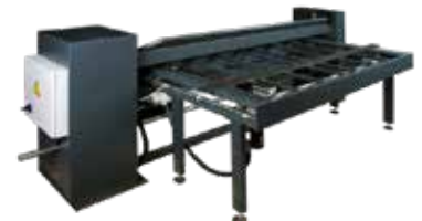
Motorisierter Hinteranschlag mit Zähler
