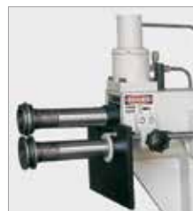
Hydraulisch einstellbare Mitlaufwalze (Sonderzubehör)
