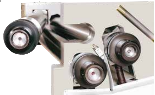
Sonderzubehör ASM-S: Verlängerte Walzen mit Profilrollen
