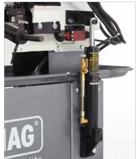
Absenkautomatik für stufenlose Vorschubeinstellung - mit Hydraulikzylinder, angebautelem Regelventil mit Drehregler und integriertem Absperrventil Links von der Zylinderstange: Endausschalter des Sägebandschutzes
