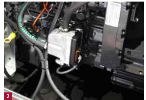
2 Kühlwasservorwärmung SEDSSF und SEDSS ECO
