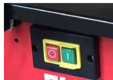
Sicherheitsschalter mit Nullspannungsauslöser
