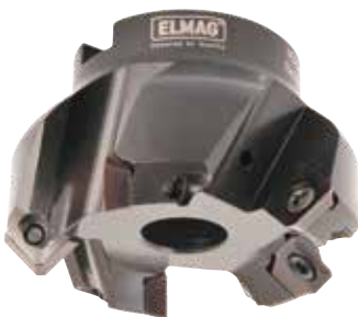
Planfräser 45°, Ø 63 mm 6 Schneiden, Aufnahme 22 mm
