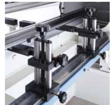
Standard: Präzises Hinteranschlagsystem der X-Achse mit AC-Antrieb
