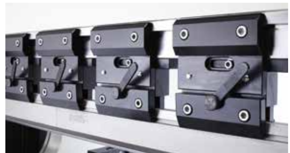
Oberwerkzeughalterung mit Schnellwechselsystem
