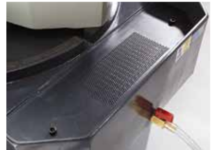
Spänewanne mit Kühlmittelbehälter, Abb. Rücklauffilter und Dosierventil
