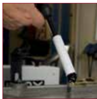
Automatische Elektrolyt-Zufuhr per Knopfdruck
