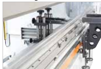
Rasch verstellbare Auflagearme mit Lineal und T-Nut
