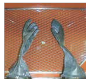
Integrierte Schutzhandschuhe aus flexiblem Kunststoff
