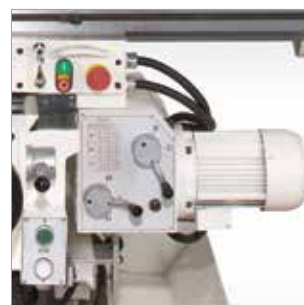
UFM 125 Spindelgetriebe mit Schnellschaltenelementen
