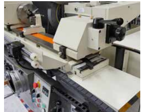
Arbeitsbereich mit integrierter Abziehvorrichtung
