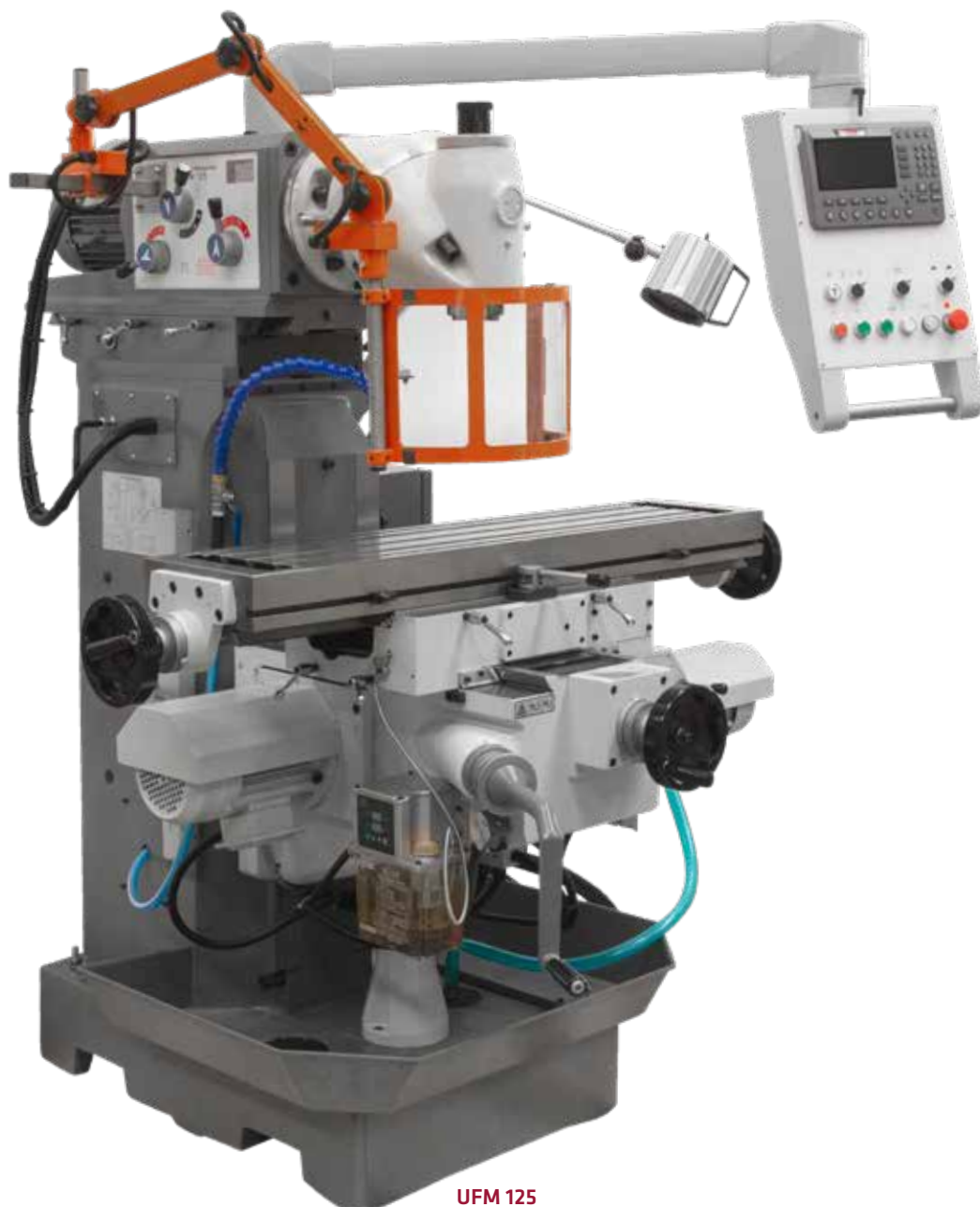
UFM 125 mit Horizontalspindel für einfachen Umbau zu Horizontalfräse
