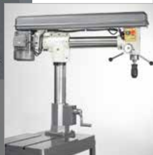
Ausleger stufenlos ± 180° drehbar
