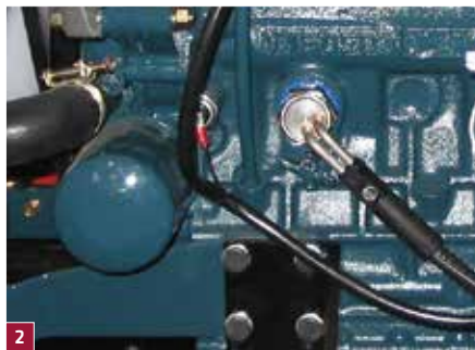
2 Kühlwasservorwärmung für KUBOTA Motoren
