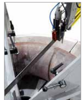
Verstellbarer Winkel für die Bearbeitung von Rohren
