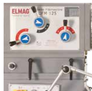
UFM 125 Spindelgetriebe mit Schnellschaltenelementen
