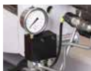
Spanndruckregelung des Spannstockes
