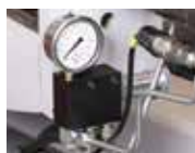
Spanndruckregelung des Spannstockes
