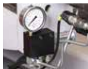
Spanndruckregelung des Spannstockes
