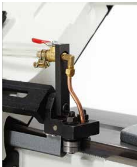
Verstellbarer Spannlagerhalter vorne für enge, sichere Sägebandführung, mit Greifschutz und präzise einstellbarem Spannlagerpaar. Integrierter, flexibler Kühlleitungsanschluss mit Dosier- und Absperrventil
