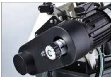
Stufenlos einstellbarer Schnittgeschwindigkeitsregler
