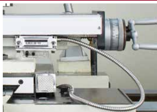
Oberschlitten mit Ableseeinheit auf einer Universal Drehmaschine
