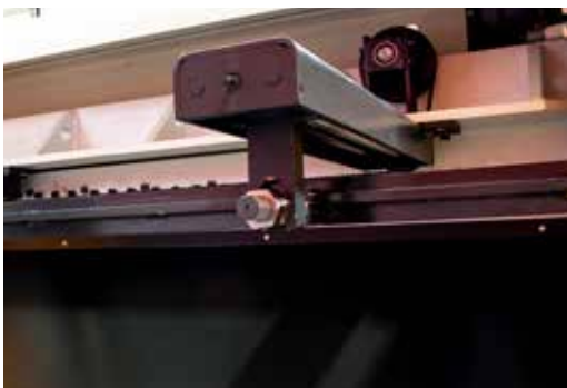
Kugelumlaufspindel am Hinteranschlag bei NC-Modellen
