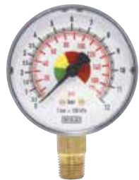
Druckmanometer für Reifenfüllgeräte Präzisionsanzeige 0 - 12 bar/psi Ø 63 mm, Anschluss Ø 1/4" unten
