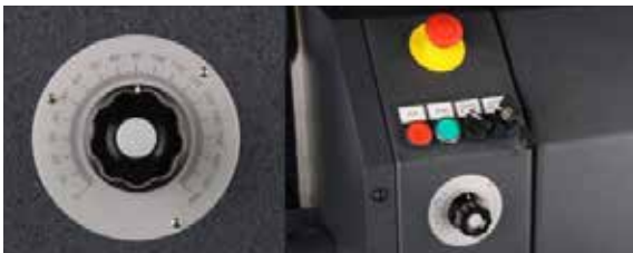
Manuelle Winkeleinstellung mittels Potentiometer
