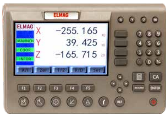
Präzise Positionsanzeige von Werkzeugmaschinen
