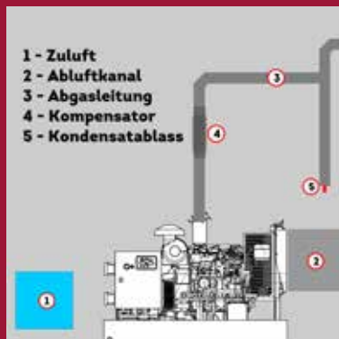
Wassergekühlte Stromerzeuger offen
