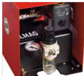
CONDOR Druckschalter, Filter-Druckminderventil, Systemdruckmanometer
