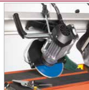
Starker Antriebsmotor und Parallelführung
