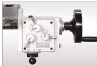
Kreuztisch X-Achse mit acht Vorschubstufen und Eilgang
