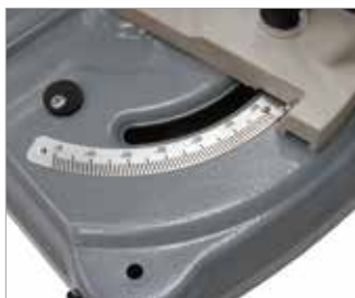
Gut ablesbare Winkelskala - einfache Gehrungseinstellung 0 bis 60°
