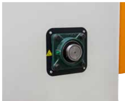
Massives Hauptlager für den Schnittzyklus
