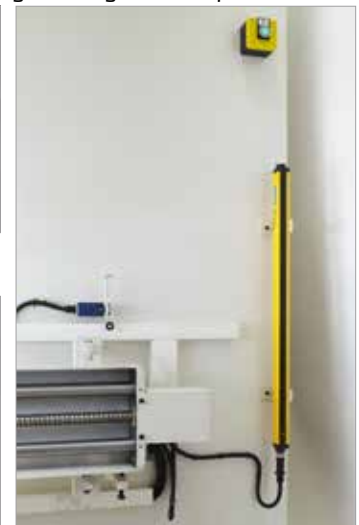
Rückseite: Lichtschranke mit Prüfeinrichtung
