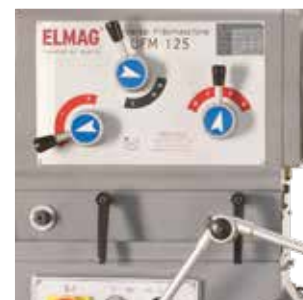
UFM 125 Spindelgetriebe mit Schnellschaltelementen
