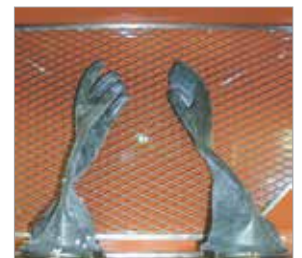
Integrierte Schutzhandschuhe aus flexiblem Kunststoff
