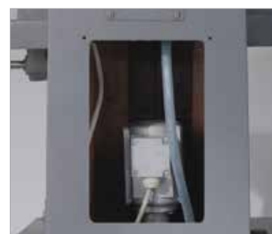
Kühlmittelpumpenmotor 90 W, Pumpleistung 25 l/min, Tank im Maschinensockel
