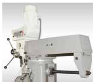
Inklusive Horizontalspindel, einfache Umrüstung
