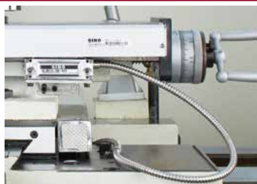
Oberschlitten mit Ableseeinheit auf einer Universal Drehmaschine
