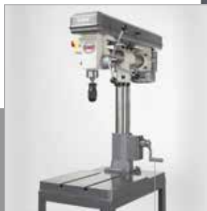
Handkurbel für Höhenverstellung bis 560 mm
