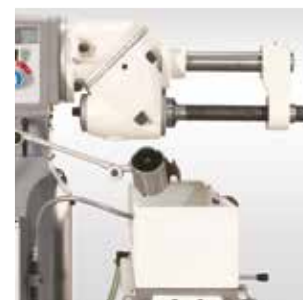
UFM 125 mit Horizontalspindel für einfachen Umbau zu Horizontalfräse
