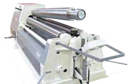
Das Ausklinken der Oberwalze erfolgt hydraulisch.
