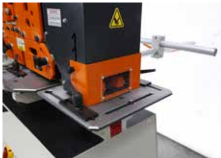
Auslinkstation mit Winkelanschlag
