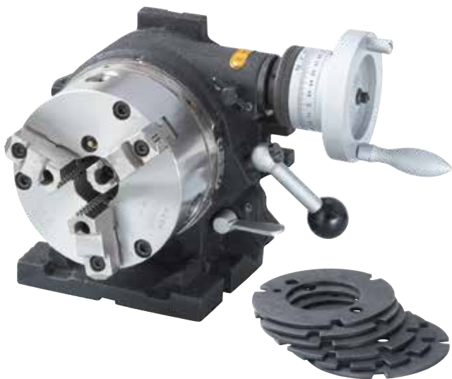
Teilapparat TAHV mit Dreibacken-Drehfutter und sechs präzisen Einrastscheiben für die Teilungen 2 x 180°, 3 x 120°, 4 x 90°, 6 x 60°, 8 x 45°, 12 x 30° und 24 x 15°
