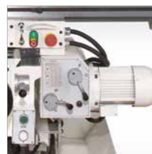
UFM 125 Spindelgetriebe mit Schnellschaltelementen
