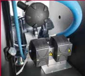
Schalldämmhauben-Heizung: Für Anlagen bei niedriger Umgebungstemperatur
