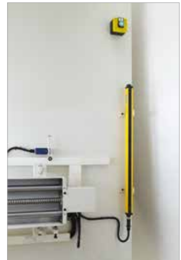
Lichtschranke mit Prüfeinrichtung
