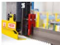
Sägebandführung aus Hartmetall
