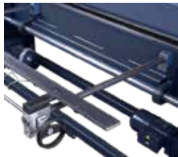
Hinteranschlag mit Handrad & Messeinrichtung
