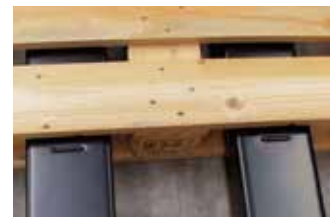
Markierung an Gabeln für optimale Positionierung des Hubwagens bei seitlichem Anheben einer Palette
