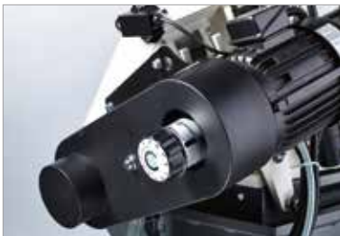
Stufenlos einstellbarer Schnittgeschwindigkeitsregler
