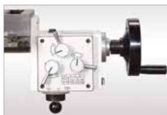
Kreuztisch X-Achse mit acht Vorschubstufen und Eilgang
