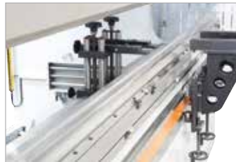
Rasch verstellbare Auflagearme mit Lineal und T-Nut
