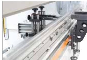
Rasch verstellbare Auflagearme mit Lineal und T-Nut
