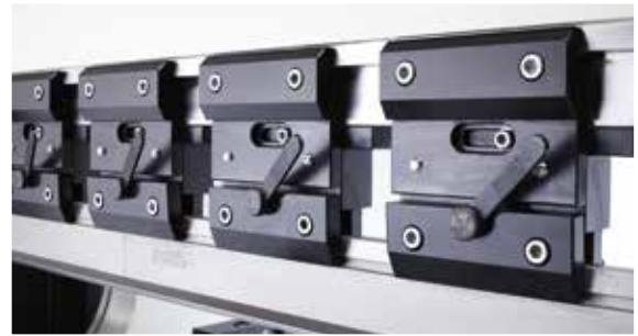
Oberwerkzeughalterung mit Schnellwechselsystem
