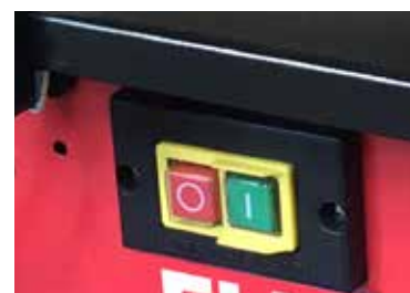
Sicherheitsschalter mit Nullspannungsauslöser
