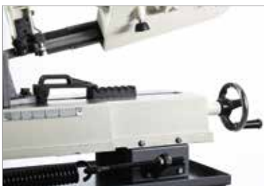
Schnellspannschraubstock mit Distanzhalter und Einstellskala
