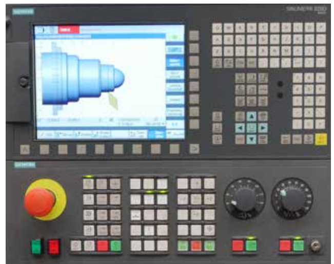
Steuerpanel mit 2 elektronischen Handrädern
