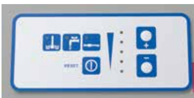
Bedienpult mit Tastatur, Led's & 5-stufiger Heizleistungs-Regelung
