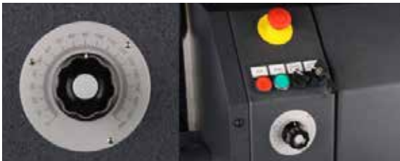
Manuelle Winkeleinstellung mittels Potentiometer
