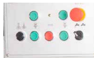
Ergonomische Anordnung der Bedienelemente
