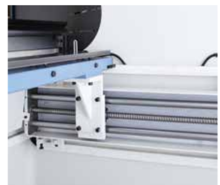
Präzise Positionierung des Hinteranschlages durch Kugelumlaufspindeln
