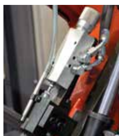
Hydraulische Schnittdrucküberwachung bei DGH-Modelle
