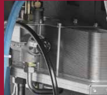
Wärmerückgewinnung zur Warmwasseraufbereitung
