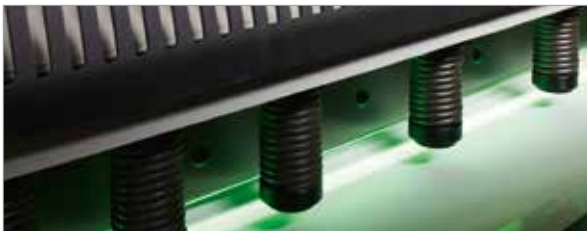
Automatisches Niederhaltersystem und Schnittlinienbeleuchtung
