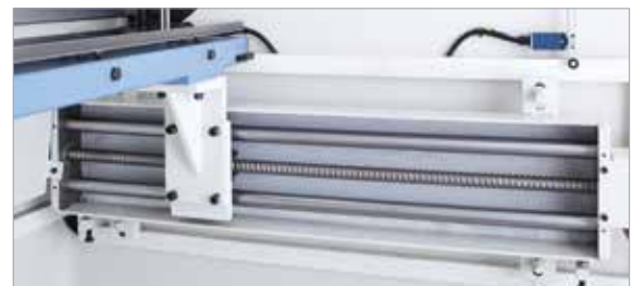
X-Achse: Positionierung über Kugelumlaufspindel
