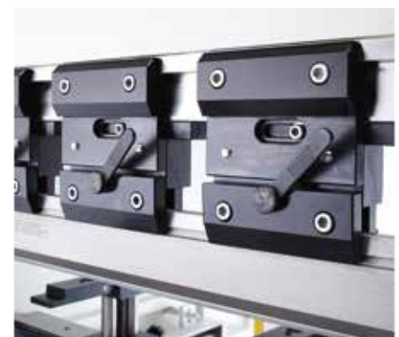
Oberwerkzeughalterung mit Schnellwechselsystem
