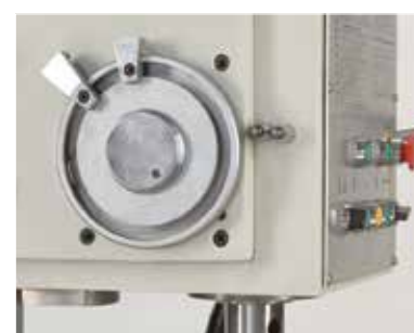
Kontaktgeber und mitlaufende, einstellbare Anschläge für die präzise Einstellung der Drehrichtungsumkehr
