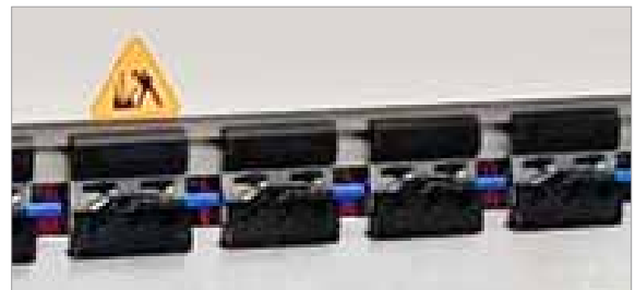
Oberwerkzeughalterung mit Schnellwechselsystem
