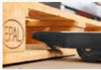
Robuster Anschlagblock an der Gabelspitze
