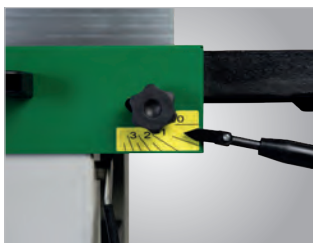
Verstellung der Spanabnahme über Bedienhebel
