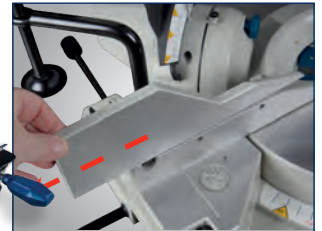
Ausziehbare Anschlagsschienen und ausziehbarer Tisch
