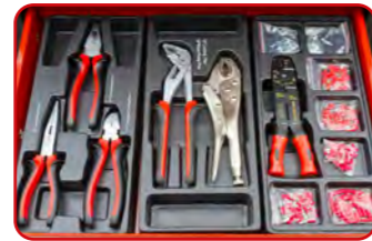
Lade 5 / drawer 5: • Kombizangen, Seitenschnieder / pliers • Wasserpumpenzange, Gripzange / locking pliers • Crimpzangenset / cramping pliers
