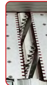
präzisionsgelagerte Spiral-Messerhobelwelle mit Wendeschneidplatten (4 Rillen a 17 Stück) precisely bedded spiral cutter block with in total 68 cutter inserts (4 grooves a 17 cutter inserts)
