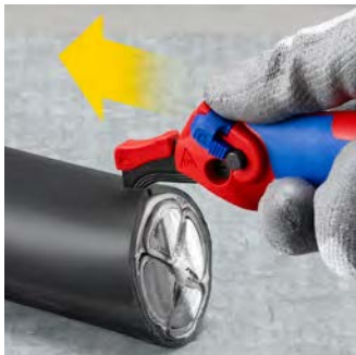
Zum Schieben oder Ziehen: zwei Klingebereiche für den Längsschnitt
