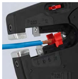
Automatisches Abisolieren bis 10 mm 2
