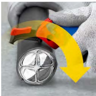
Dritter Klingebereich für Umfangsschnitt
