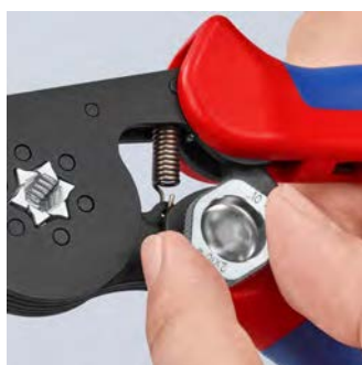
97 53 14 / 97 55 14: Die Crimpzange kann mit dem Stellrad auf große Aderendhülsen von 16 mm 2 oder 2 x 10 mm 2 eingestellt werden
