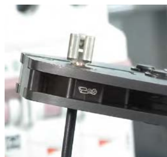
Gut sichtbare Kennzeichnung der Crimpeinsätze mit Piktogrammen
