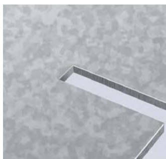
Ausklinken und Spanbrechen in einem Arbeitsgang
