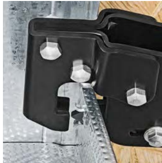
Das Stempelwerkzeug wird durch die Profilbleche gedrückt
