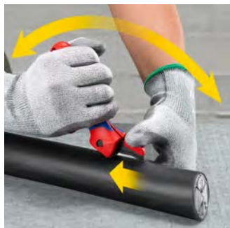
Durch Ratschenfunktion mit mehr Komfort und weniger Kraftaufwand abmanteln
