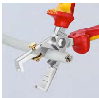
Induktiv gehärtete Scherschneide mit Präzisions-schliff zum quetschfreien Schneiden von Cu- und Al-Kabeln bis Ø 15 mm (5 x 2,5 mm²)
