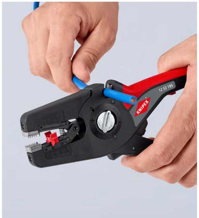
Mit obenliegendem Kabelschneider für Cu- und Alu-Leiter feindrähtig bis 16 mm 2 (AWG 6), eindrähtig bis 6 mm 2 (AWG 10)
