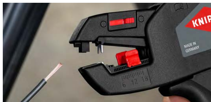
Feinjustierung ermöglicht die genaue Einstellung der Einschnitttiefe auf spezielle Materialien oder Temperaturbedingungen
