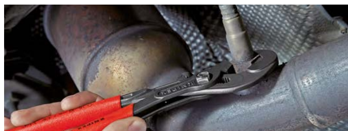
Arbeiten an verrosteter Mutter mit verrundeten Kanten
