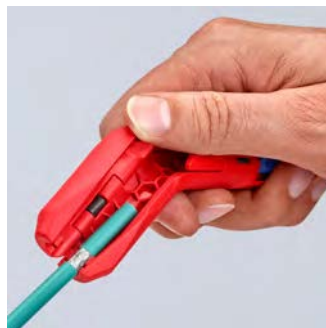
Abmanteln eines Datenkabels
