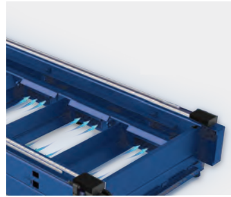
Schneiden mit sauberer Luft durch Zonenbelüftung
