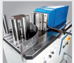
▶ Mit Schnellwechselaufnahme und Seitenanschlag mit Skala
