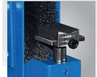
▶ Mit verstellbarer Prismen Werkstückauflage
