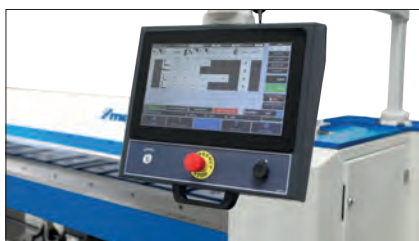
Bedienerfreundliche 15,6“ Touchscreen NC-Steuerung an ergonomischen Schwenkarm
