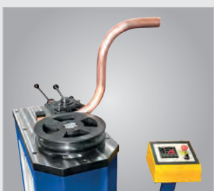
▶ Biegewinkel bis 180° möglich
