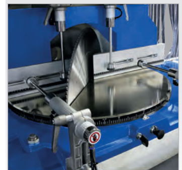
▶ Stufenlose Verstellung des Gehrungswinkels
