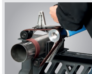
▶ Nur zwei Arbeitsschritte notwendig für 360° Umfangschleifen
