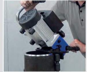
Entgraten von Rohren möglich
