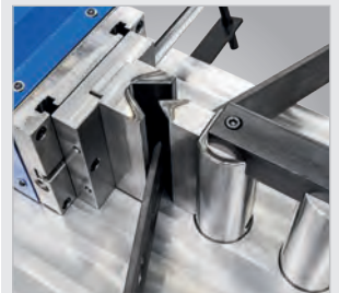
▶ Mit Schnellwechselaufnahme und Seitenanschlag mit Skala
