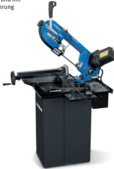
MBS 155 K serienmäßig mit Unterbau, Kühlmittleinrichtung, Kühlmittelleitblech und 60% Einschaltdauer
