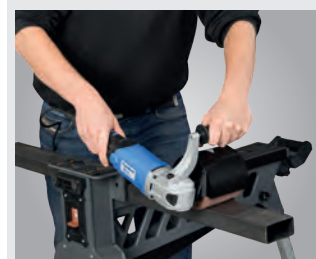
▶ Satinieren von flachem Material
