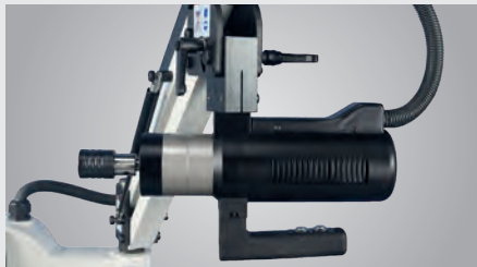
▶ Maschinenkopf von 0 bis 90 Grad schwenkbar
