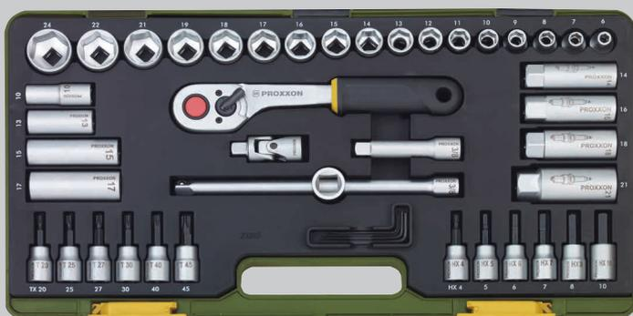
Steckschlüsseleinsätze von 6 – 24 mm. Tiefbettsätze 10 – 17 mm, (für weit überstehende Gewindebolzen). Zündkerzen-Spezialeinsätze 14, 16, 18 und 21 mm. Schraubereinsätze mit Vierkantantrieb für Innensechskantschrauben (4 – 10 mm) und TX-Schrauben (20 – 45). 2 Verlängerungen. Kreuzgelenk. Innensechskantschlüssel Gr. 1,25 – 1,5 – 2 – 2,5 und 3 mm. Sonstiger Inhalt siehe Abbildung.
