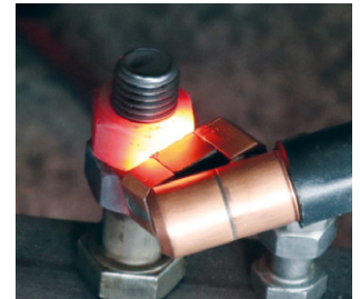
› Erwärmen einer Mutter mit der Fokusspule schräg
