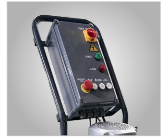
• Bedienung über mobiles Steuerpult
