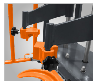
› Stufenlos einstellbare Aufnahmebacken
