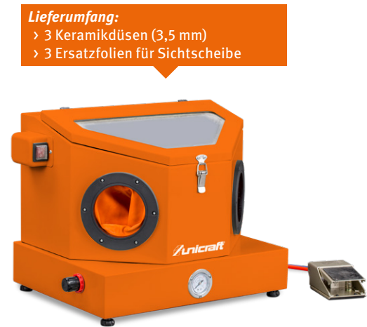
SSK 1.5 ▶ Regulierung des Arbeitsdrucks über Druckregler mit Manometer ▶ Steuerung des Luftstroms erfolgt über Fußpedal ▶ 12-Volt-Leuchtstoffröhre mit 230-Volt-Netzteil und externem Schalter ▶ Integrierte Absauganlage mit auswechselbarem Luftfilter
